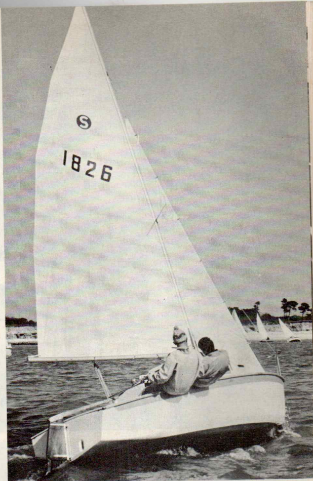
Sous voiles, le Surcouf se comporte exactement comme le Corsaire et il exige de son équipage qu'il se mette souvent au rappel pour éviter un trop grand angle de gîte, qui rend le bateau ardent.
