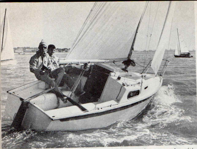
Le cockpit, de même dimension que celui du Corsaire, est coupé par une longue barre d'écoute en bois, assez encombrante, mais efficace pour contrôler la grand-voile.
