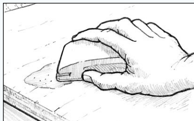
Figure 23 Poncer les composants enduit une fois durcis pour obtenir le profil désiré.
