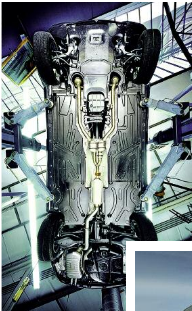
Figure 20 : Dans les systèmes d'échappement automo- bile, l'inox est le maté- riau de référence. Les parties élastomères des fixations préviennent la corrosion galvanique.
