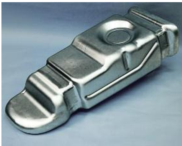
Figure 21 : L'inox est de plus en plus utilisé pour les réservoirs de carburant. Les fixa- tions qui les tiennent en place assurent l'isolation électrique à la jonction.
