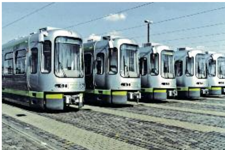
Figure 22 : Des techniques simples d'isolation rendent la structure en inox ferritique du tram compatible avec le châssis en acier au carbone.
