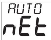
Seulement utilisable sur l'instrument qui a allumé le système (Master). Revoir la notice de mise en réseau (Auto Networking) pour plus d'informations.
