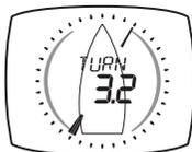
L'aiguille montre la direction de la destination à atteindre relatif à la proue du bateau. L'afficheur indique la distance jusqu'à l'objectif. La distance est affichée dans les unités de distance qui ont été sélectionnée (par défaut en miles nautiques).
