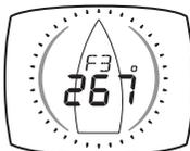
La vitesse du vent réel et la direction sur l'eau sont affichées en utilisant l'échelle de Beaufort (de 0 à 12). Cette valeur est calculée par l'afficheur en tenant compte de la vitesse et du cap du bateau. La vitesse du vent apparent, son angle, la vitesse et le cap du bateau sont des mesures indispensables pour ce calcul.
