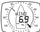
L'angle du vent réel est calculé par les instruments à partir des mesures de vent apparent (vitesse et direction) et de vitesse du bateau. Ces dernières données sont indispensables au calcul.
