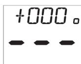
Aligne la valeur affichée de vent apparent avec la valeur réelle du vent apparent (décalage de montage). Voir page 18 pour la calibration.
