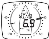
L'angle du vent réel est calculé par les instruments à partir des mesures de vent apparent (vitesse et direction) et de vitesse du bateau. Ces dernières données sont indispensables au calcul. L'angle du vent est affiché sur une échelle de 26 à 60 °. Avec le vent arrière, la même échelle
