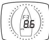
La vitesse du vent réel sur l'eau sont affichées en utilisant l'échelle de Beaufort et les knots.
