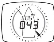
La route fond du voilier est calculée par l'antenne GPS. La flèche analogique indique le Nord.
