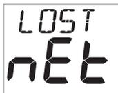
Sur un instrument isolé, cette alarme indique que cet instrument a perdu le contact avec le " Master\* ", que le " Master " a un problème ou que l'instrument a été trop éloigné de sa plage de fonctionnement.
