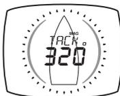
Cap qu'aurait le voilier s'il virait de bord face au vent et se retrouvait au même angle de remontée sur l'autre bord. Cette valeur est calculée par l'afficheur à partir de l'angle de vent apparent et du cap du voilier. Toutes ces mesures sont indispensables pour le calcul.
