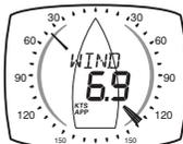
Angle du vent et vitesse mesurés par la girouette.
