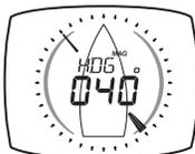
Cap magnétique actuel d'un bateau, mesuré par le capteur magnétique
