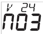
Affiche le numéro de version du logiciel, le niveau de charge et le coefficient de charge pour aider au dépannage. Si l'instrument est le " Master " (celui qui a allumé le système), le nombre de nœuds du réseau (instruments reliés) est affiché. Si l'instrument est esclave (s'est allumé par la mise
