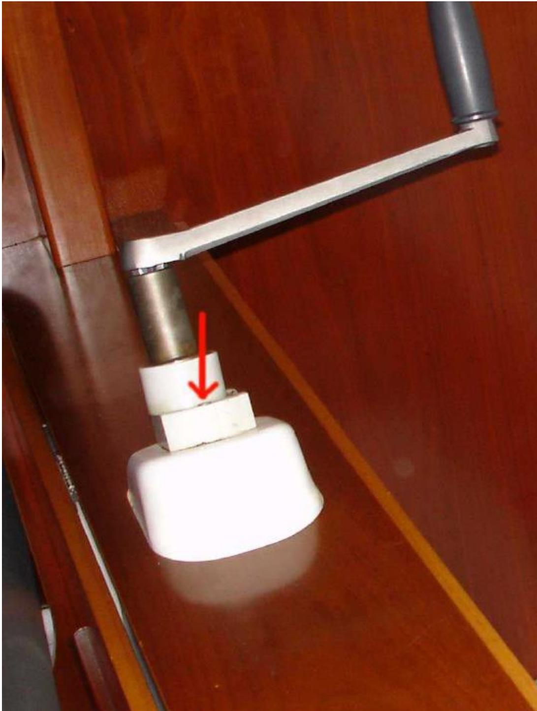
On peut ensuite sortir la vis, en la dévissant, il suffit alors d'appliquer la graisse directement dessus
