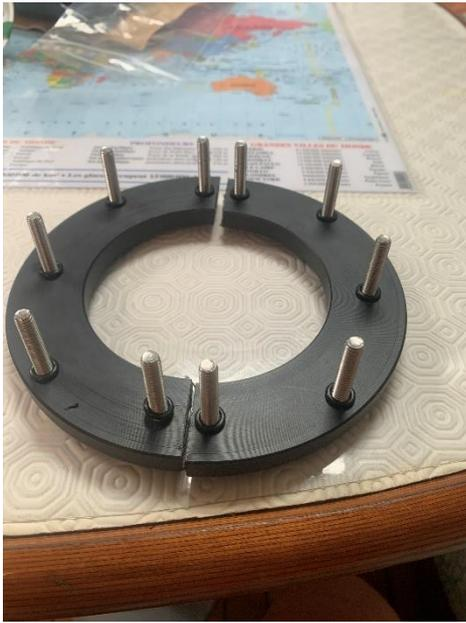
Bague coupée en deux après traçage et perçage des 10 trous, afin de pouvoir la rentrer à l'intérieur du réservoir.
