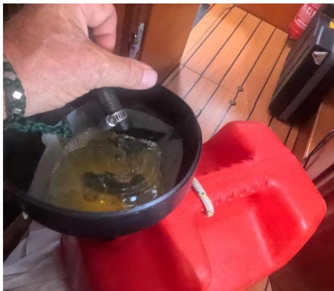
La vidange du réservoir est effectuée avec la pompe électrique installée en remplacement de la pompe mécanique d'origine.
