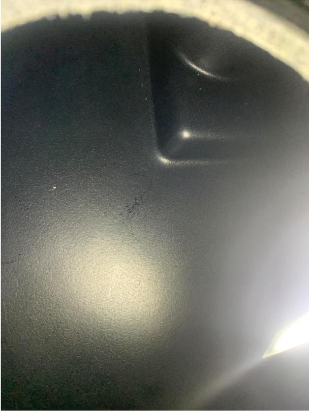
C'est avec un tissu absorbant que j'ai sorti le gasoil et les bactéries restantes, ne pouvant être pompées.
