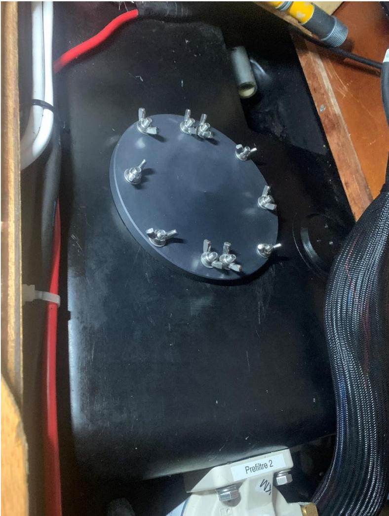
Pose et serrage du bouchon avec écrous papillon inox
