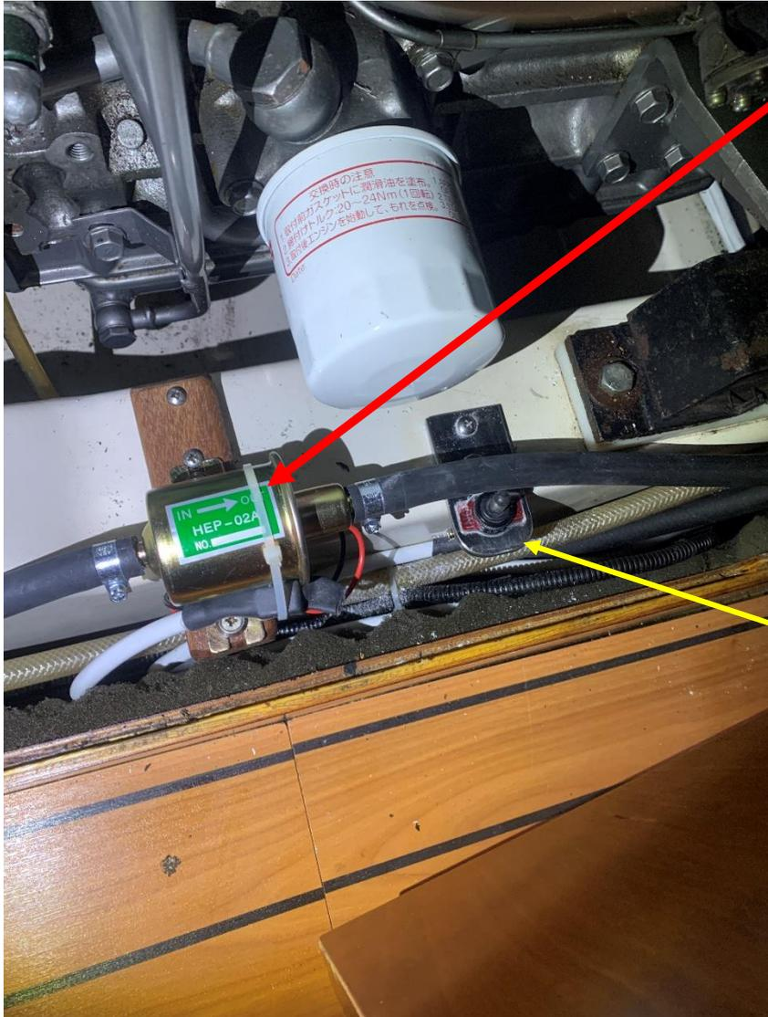
La **pompe électrique** permet de purger facilement et rapidement le circuit lors des remplacements de filtres, un démarrage toujours parfait, et une possibilité de diagnostic plus rapide en cas de problème, genre celui-ci.
