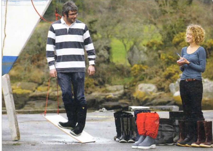
▲ Nous avons apprécié l'adhérence des différentes semelles à l'aide de ce dispositif réglable.
