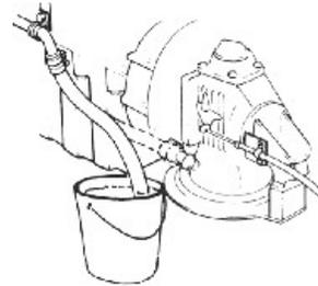
Mettre le moteur en marche et le laisser tourner au ralenti jusqu'à ce que le seau soit vide. Arrêter le moteur immédiatement, car la pompe à eau ne supporte pas de tourner à sec.
