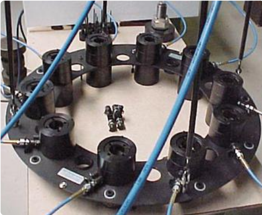
Exemple d'outillage pour serrage semi-simultané (50%) de couvercle de cuve pour produits chimiques
