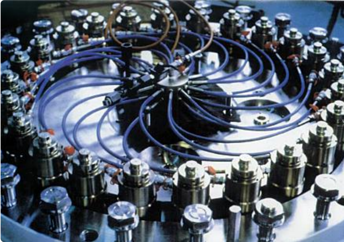
Machine de serrage et de desserrage de goujons de cuves de réacteurs nucléaires
