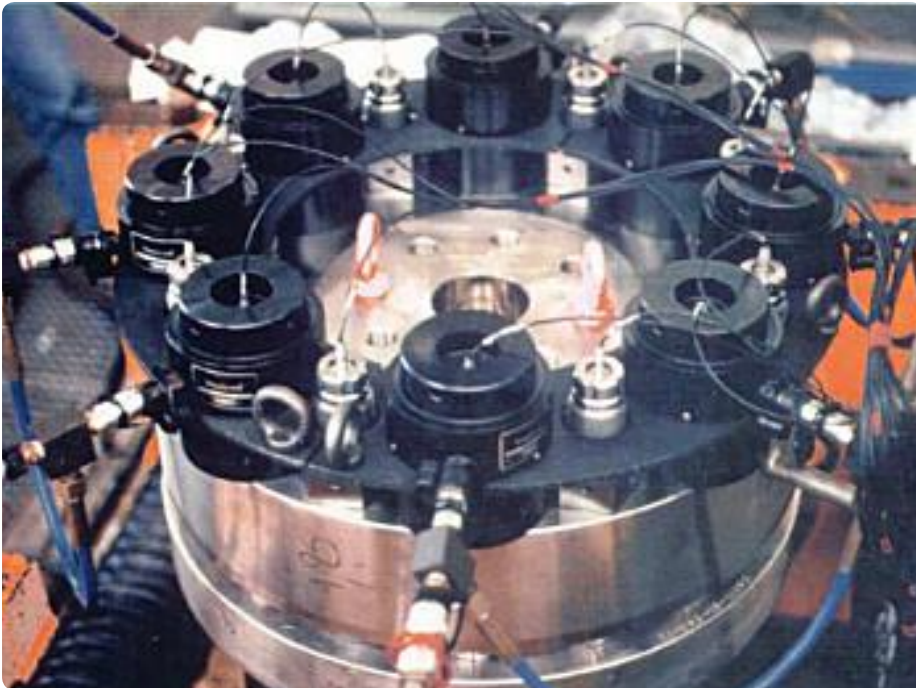
Exemple d'outillage de serrage semi-simultané (50%) de valve de grande dimension dans une application de pétrochimie
