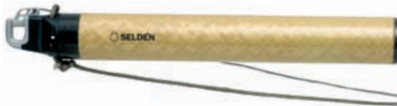
Protection en Twaron en option. Les filaments de Twaron protègent le tangon contre le ragage sur l'étai ou les haubans.
