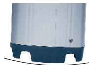
Emplanture convexe sous le pied de mât répartit la compression sur la section du mât.
