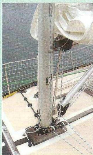
**Le mât est posé sur le pont. La plupart des manœuvres sont renvoyées au cockpit.**
