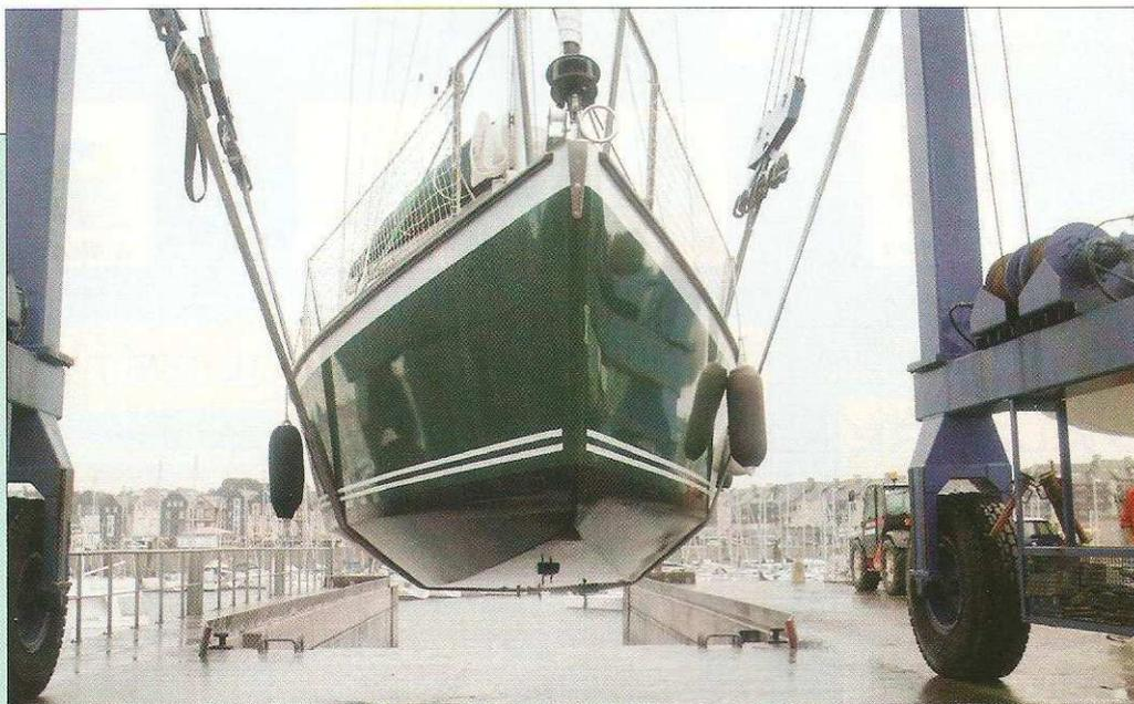
**Le Cruff 24 est une carène à bouchains vifs, ici un double bouchain à fond plat. Ce qui lui permet de reposer à plat à l'échouage. Mieux vaut viser un fond de sable ou de vase.**
