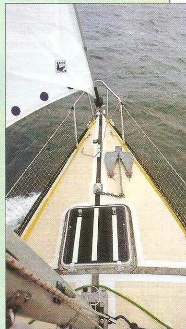
**L'ancre est maintenue sur la plage avant, la chaîne passant dans un écubier.**
