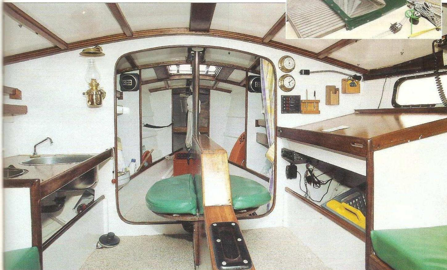
*Le traitement des emménagements intérieurs avec ses barrots vernis et les lisses apparentes est très réussi. Remarquez le hublot de coque au-dessus de la table à cartes et la fenêtre au premier plan qui permet de vérifier la position de la dérive.*
