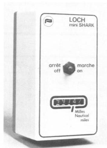
Le Mini-SHARK se place sur une cloison verticale. Fixer deux vis à tête bombée dans le plan vertical à 97 mm d'entre axe, afin que le boîtier muni de deux trous oblongs sur sa partie arrière puisse venir s'y bloquer.
