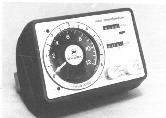
L'étrier orientable permet de fixer le loch speedomètre horizontalement sur une paroi verticale ou bien au plafond. Il se place en général devant la table à cartes, les boutons de commande à portée du navigateur.
